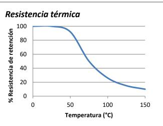
"Resistencia térmica" Pruebas de resistencia realizadas en acero. Ejemplares completamente curados y condicionados a la temperatura de prueba durante 30 minutos antes de la prueba.
