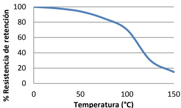
Resistencia térmica pruebas de resistencia realizadas en acero. Curado de 24 hr a temperatura ambiental y condicionado a la temperatura de prueba durante 30 minutos.
