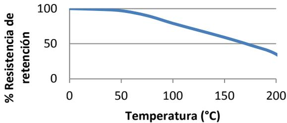
Resistencia térmica pruebas de resistencia realizadas en acero. Curado de 24 hr a temperatura ambiente y condicionado a la temperatura de prueba durante 30 minutos.
