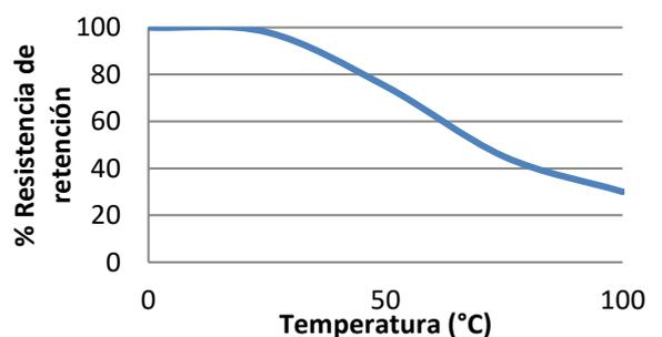
\*Re Ejemplares completamente curados y condicionados a la temperatura de prueba durante 30 minutos antes de la prueba.
