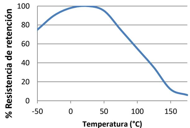
Resistencia térmica. pruebas de resistencia realizadas en acero. Curado de 24 horas a temperatura ambiental y condicionado a la temperatura de prueba durante 30 minutos.
