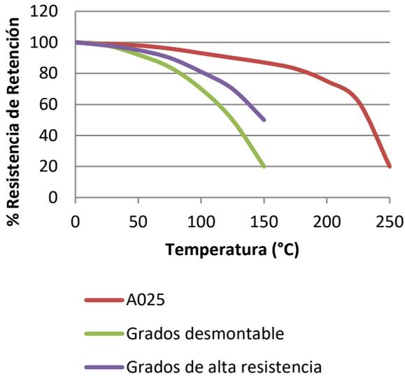
"Resistencia Térmica" Resistencia a rotura en tuercas y tornillos zincados de M10 según la norma ISO 10964. Curado a 23°C durante 24 horas y después acondicionado durante 30 minutos a temperatura de prueba.
