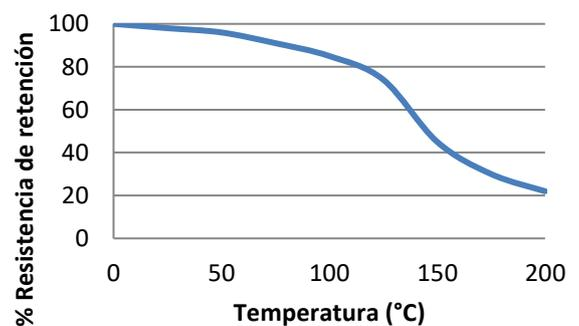
**“Resistencia térmica” Pruebas de resistencia realizadas en acero. Ejemplares completamente curados y condicionados a la temperatura de prueba durante 30 minutos antes de la prueba.**
