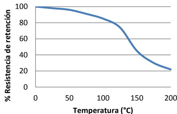
**Resistencia térmica. pruebas de resistencia realizadas en acero. Ejemplares completamente curados y condicionados a temperatura durante 30 minutos antes de la prueba a temperatura.**
