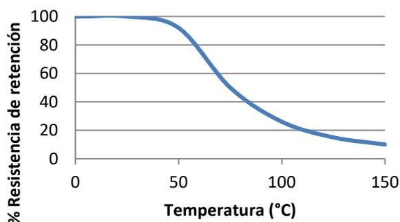
Resistencia térmica" Pruebas de resistencia realizadas en acero. Ejemplares completamente curados y condicionados a la temperatura de prueba durante 30 minutos antes de la prueba.
