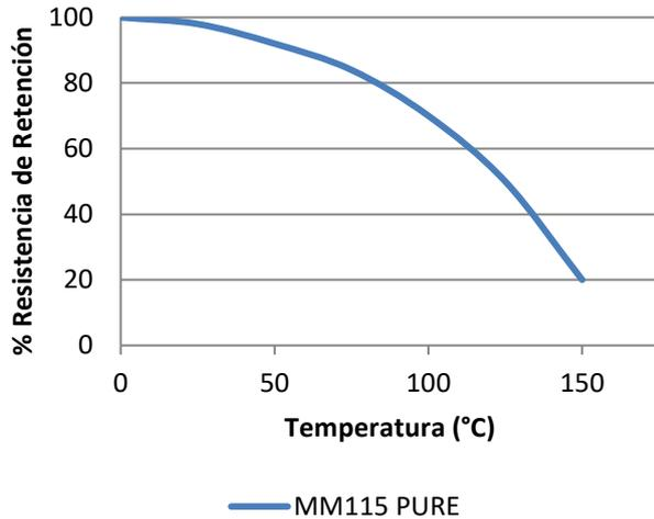
*"Resistencia Térmica" Resistencia a rotura en tuercas y tornillos zincados de M10 según la norma ISO 10964. Curado a 23°C durante 24 horas y después acondicionado durante 30 minutos a temperatura de prueba.*
