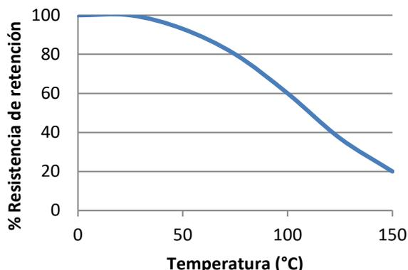
Resistencia térmica pruebas de resistencia realizadas en acero. Curado de 24 hr a temperatura ambiental y condicionado a la temperatura de prueba durante 30 minutos.
