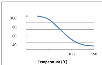
Pruebas de resistencia al cizallado de "resistencia al calor" realizadas en acero templado. Muestras completamente curadas acondicionadas para alcanzar la temperatura durante 30 minutos antes del análisis a temperatura.
