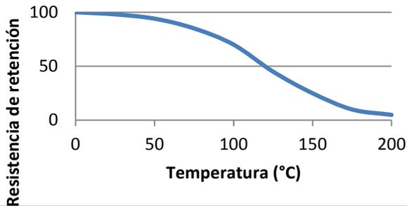
Resistencia térmica pruebas de resistencia realizadas en acero. Curado de 24 hr a temperatura ambiente y condicionado a la temperatura de prueba durante 30 minutos..
