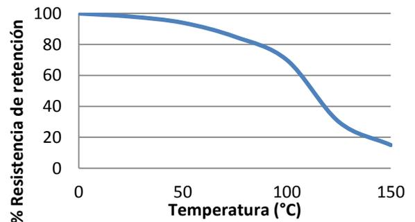
Resistencia térmica pruebas de resistencia realizadas en acero. Curado de 24 hr a temperatura ambiental y condicionado a la temperatura de prueba durante 30 minutos.
