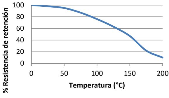
Resistencia térmica pruebas de resistencia realizadas en acero. Curado de 24 horas a temperatura ambiente y condicionado a la temperatura de prueba durante 30 minutos.
