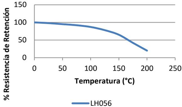
"Resistencia Térmica" Resistencia a rotura en tuercas y tornillos zincados de M10 según la norma ISO 10964. Curado a 23 °C durante 24 horas y después acondicionado durante 30 minutos a temperatura de prueba.
